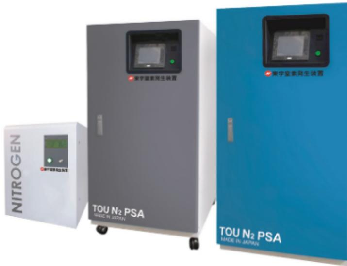
空气中有78%是氮气，因此氮气设备的应用中，氮气的纯度是多少，就是非常重要的指标。如何知道氮气纯度的检测方法，主要以含氧分析仪检测气体内含有的氧浓度后，反推氮气纯度为主。目前氮气发生器中采用的侦测氧浓度的分析仪主要有两种原理：电化学及氧化锆。氧化锆是具有离子导电性质的陶瓷固体，氧化锆传感器式氧分析仪主要优点是精确度较高，可监测微量氧浓度，定期校准即可，但是价格较高。电化学的优点是价格较低，但是原电池的特性关系，属于耗材，无论使否有使用，原电池都会退化，每年需更换一次。
